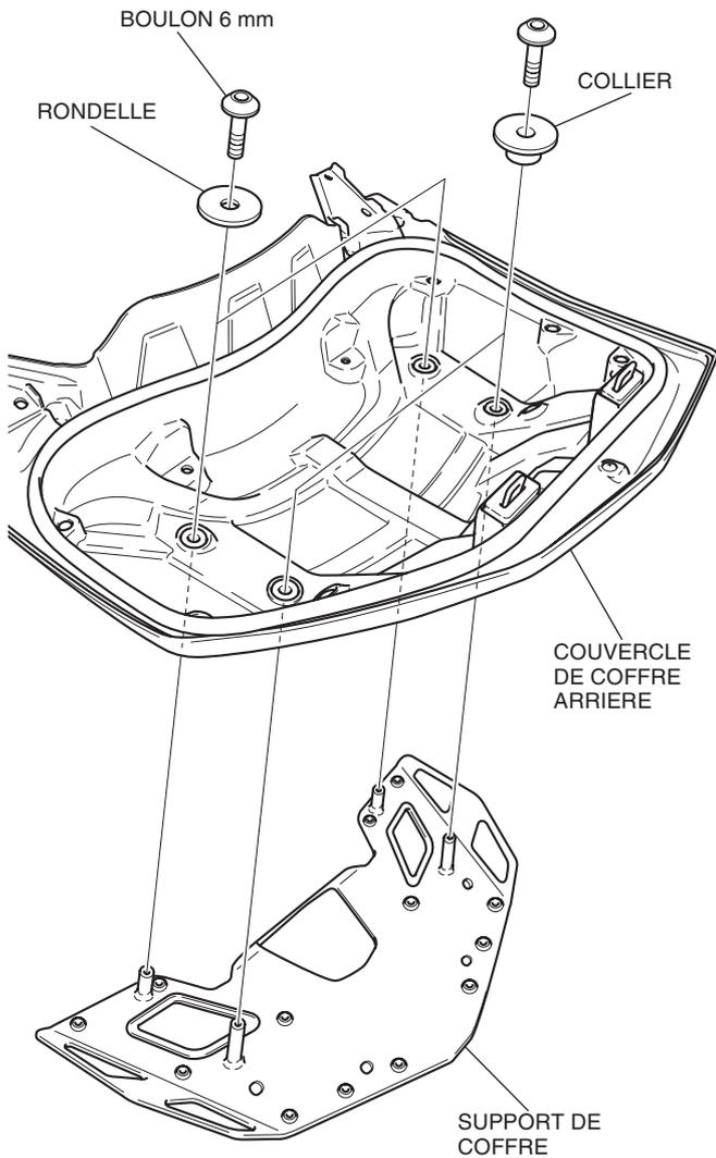
47. Montez le couvercle de coffre arrière dans l'ordre inverse de la dépose.
